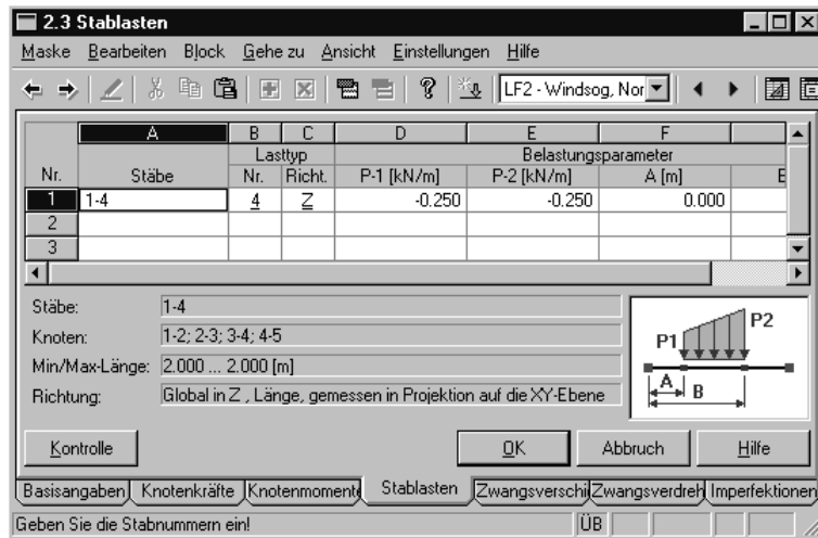
Bild 20 Beispiel 2 - Gleichlast über gesamten Träger
